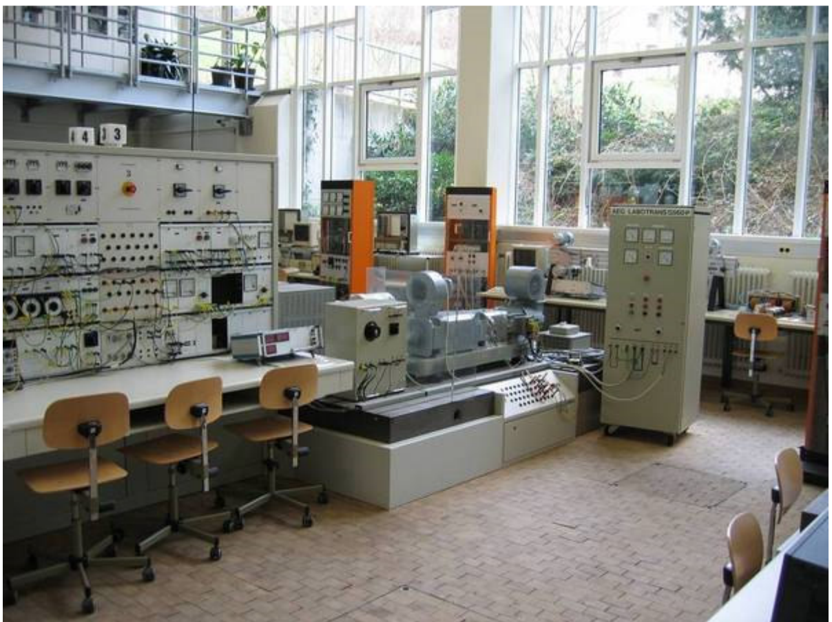
Arbeitsplatz 3: Drehstromasynchronmaschine mit Schleifringläufer Raum: T010
