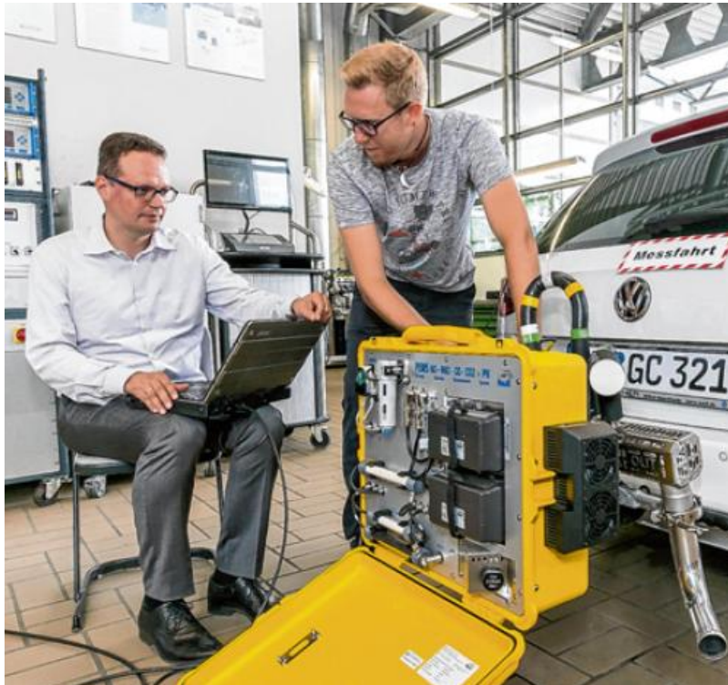
Professor Gregor Bischoff (links) und Laborleiter Florian Kennerknecht beim Kalibrieren des AIP-Testkoffers: Damit dessen Systeme Schadstoffe exakt messen können, müssen sie vor jeder Fahrt geeicht werden. Foto: Ralf Lienert
