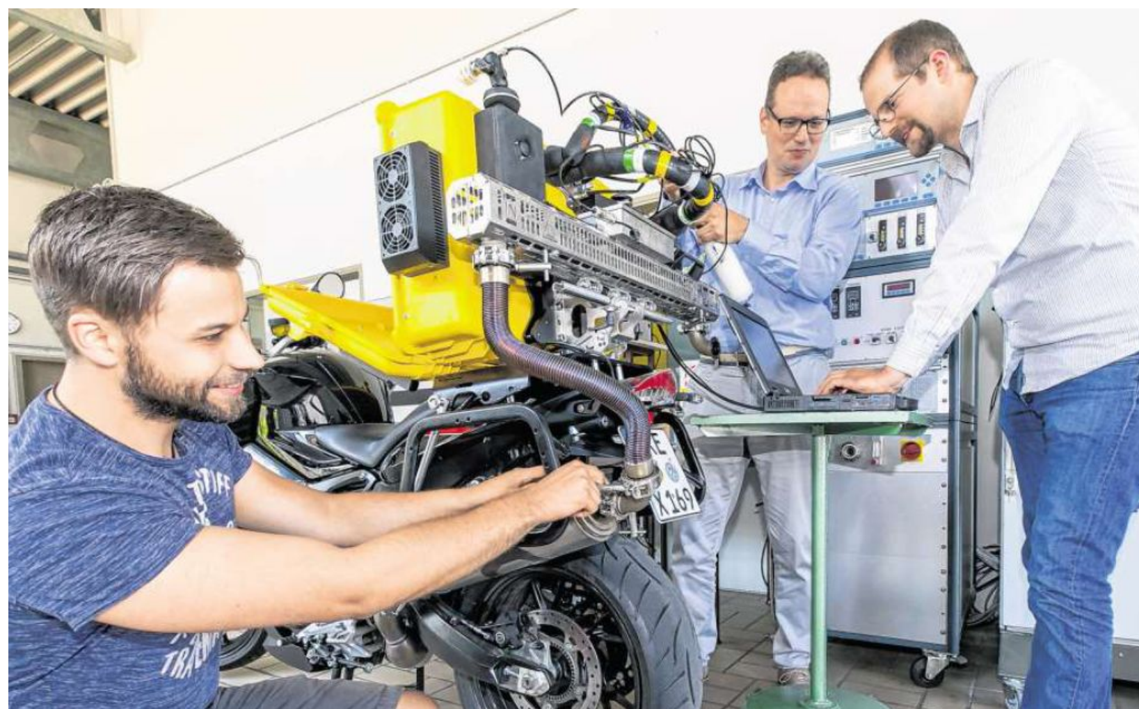
Drei, die genau wissen, was sie tun: Stefan Keller (links, er schreibt gerade an seiner Master-Arbeit über Schadstoffemissionen bei Motorrädern), Professor Dr. Gregor Bischoff (Mitte, Fakultät Maschinenbau an der Hochschule Kempten) und Dr. Alexander Heubuch (AIP Automotive) beim Einstellen des AIP-Testkoffers. Damit der exakte Werte liefert, muss er vor jeder Testfahrt mit Normgasen kalibriert werden. Foto: Ralf Lienert
