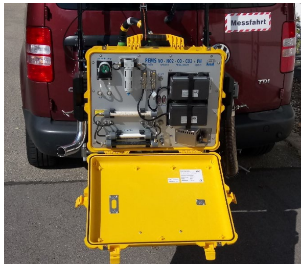
Abbildung 1: PEMS an Fahrzeug montiert
